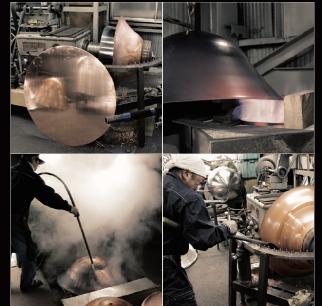
1枚のコピー板、あるいは、アルミ板に、熟練のクラフトマンがヘラを押し当てて、成形していく技術。ヘラのみで均一に仕上げられたケトルは、ヘラ絞りと熱処理を繰り返し、強度を増すことで、音感に優れ、サウンドの輪郭をはっきりと際立たせます。
